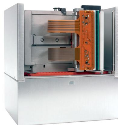
I limitati componenti soggetti a usura sono facili e veloci da sostituire, per fornire ai clienti l'opportunità di tornare velocemente produttivi. Grazie a una nuova concezione, anche la testa di stampa è facile da sostituire e non richiede interventi ulteriori da parte dell'operatore per tornare a stampare.
